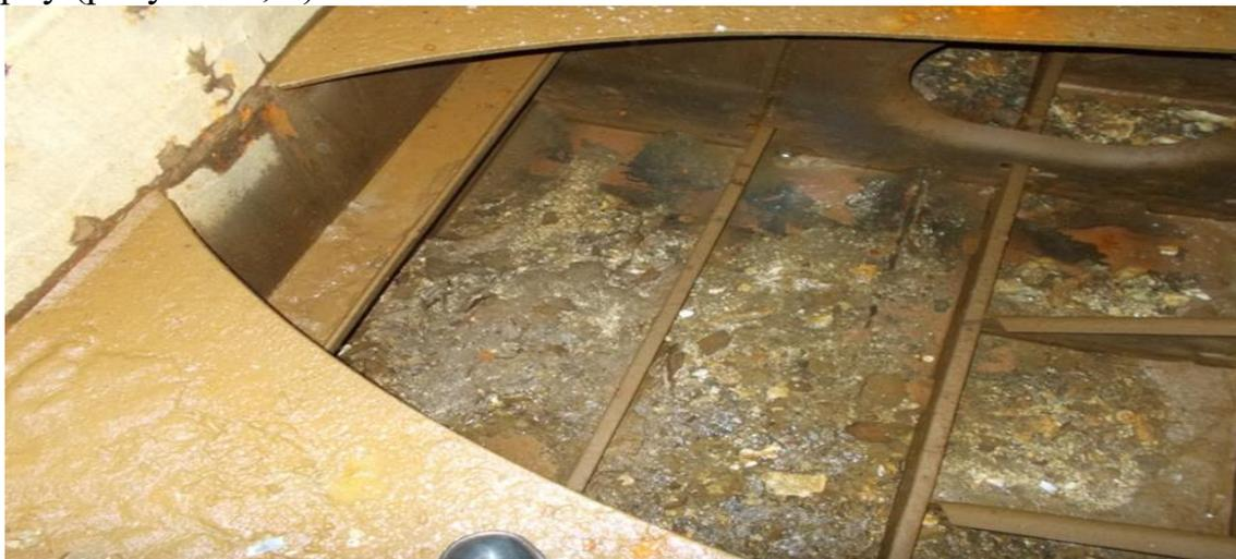
Рисунок 1. Нижняя часть балластного танка (теплоход «Волга 4004»).
