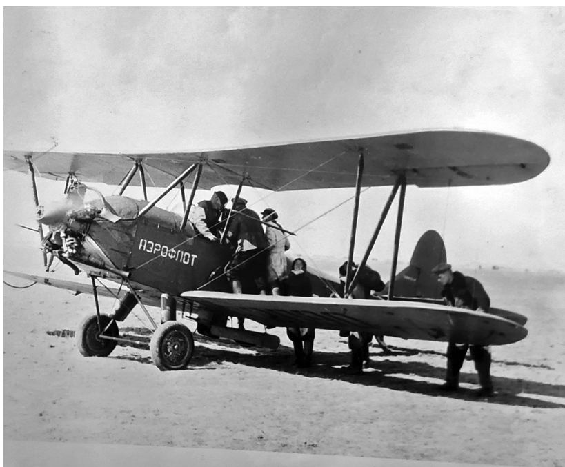
Загрузка самолёта ПО-2 приманкой для истребления грызунов с помощью малой авиации
